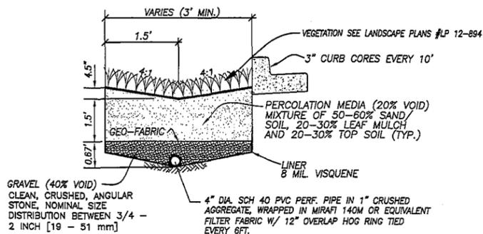
**BIORETENTION OPERATION & MAINTENANCE REQUIREMENTS**
