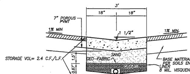
**POROUS CONCRETE SWALE/BIORETENTION OPERATION & MAINTENANCE REQUIREMENTS**
