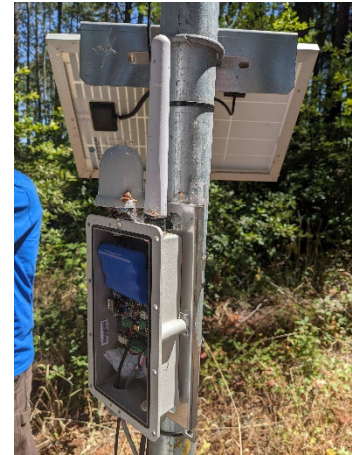
Figura 2. Un poste con panel solar, antena y medidor para recibir y teledir datos.
